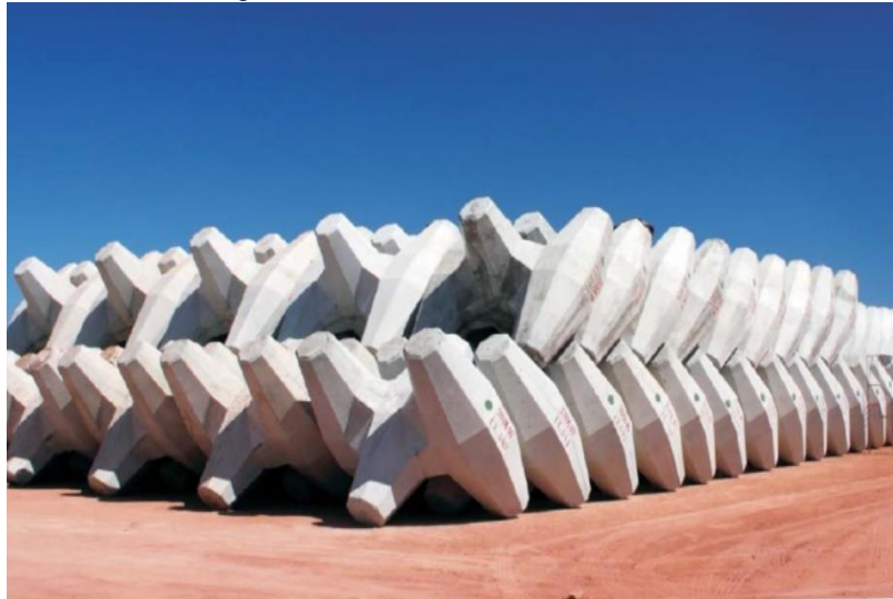
Figura 12- Armazenamento Corelocs
